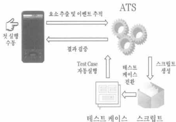
(그림 1) 위젯 기능 테스트 자동화 실행 절차
