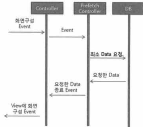
(그림 2) MVC+Prefetch Controller 동작 Flow
