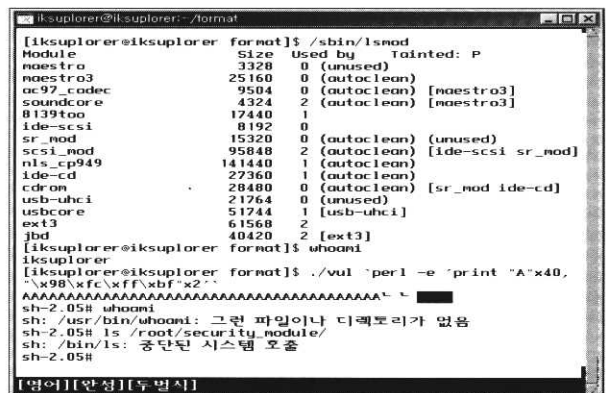
(그림 11) 보안커널모듈 로드후 셸코드 공격 결과
