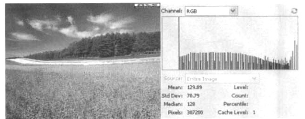
(그림 10) 기존의 히스토그램 평활화 기법을 적용한 영상 (Figure 10) Basic histogram equalized image
