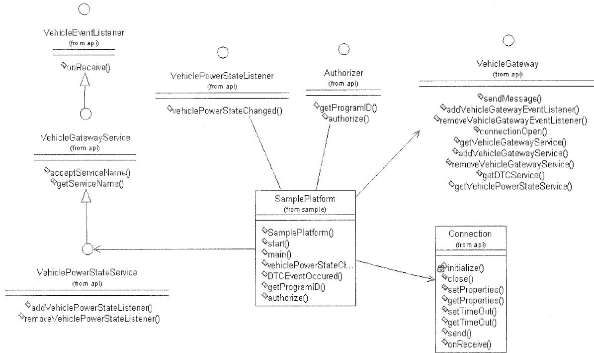
(그림 9) 차량 정보 관리 및 차량과의 통신 기능의 클래스 다이어그램
